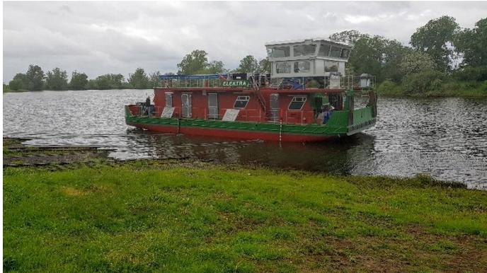
Im Steuerhaus wird weitergebaut und auch der Steuerstand wird hier eingebaut, die Wohnung wird ausgebaut und eingerichtet und es fehlt noch das Wasserstofftanksystem zur Versorgung der Brennstoffzellen.
