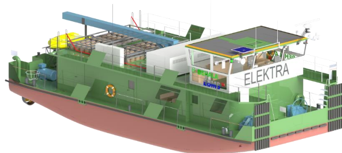
Abbildung: 3D Modell des Schubbootes ELEKTRA
